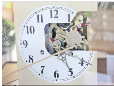
Der rote Hebel am hinteren Ende des Stundenzeigers treibt das mit Zapfen versehene hölzerne Kammrad voran.
